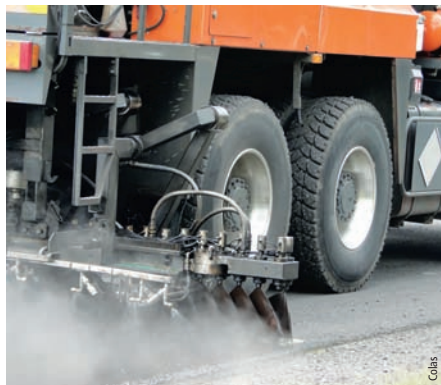
Photo 17 Procédé EMULCOL® (rampe côté rupteur)
