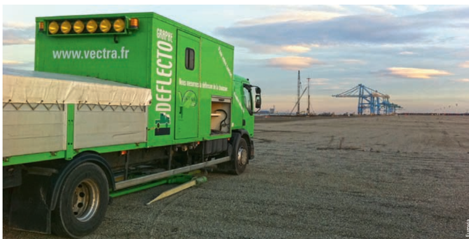
Photo 2 Relevés de déflexion au déflectomètre Lacroix Reflection surveying with Lacroix deflectometer
