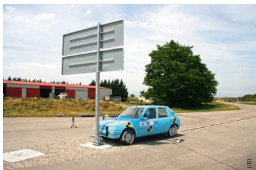
Le LIER réalise des crash-tests en grandeur réelle
