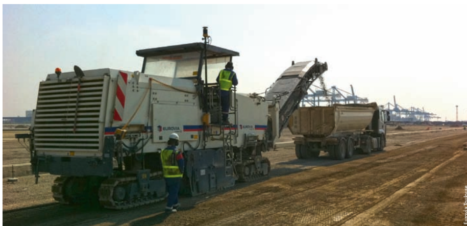
Photo 1 Raboteuse WR 2000 guidée Wirtgen WR 2000 guided planing machine
