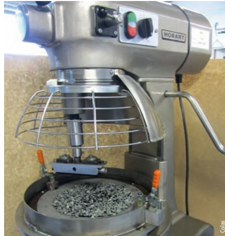
Photos 6 et 7 Appareillage pour essai ACTE ACTE Device
