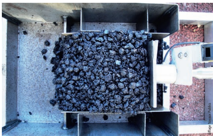
Photo 1 Aspect de l'enrobé Biocold à l'issue de sa fabrication, durant un essai de maniabilité (Maniabilimètre Nynas) Appearance of Biocold asphalt after manufacture during a workability test (Nynas workability meter)
