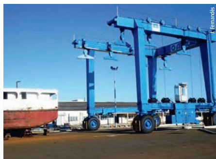
Photo 7 Élévateur à bateau et plate-forme en EME Ship elevator and EME (high-modulus asphalt) platform
