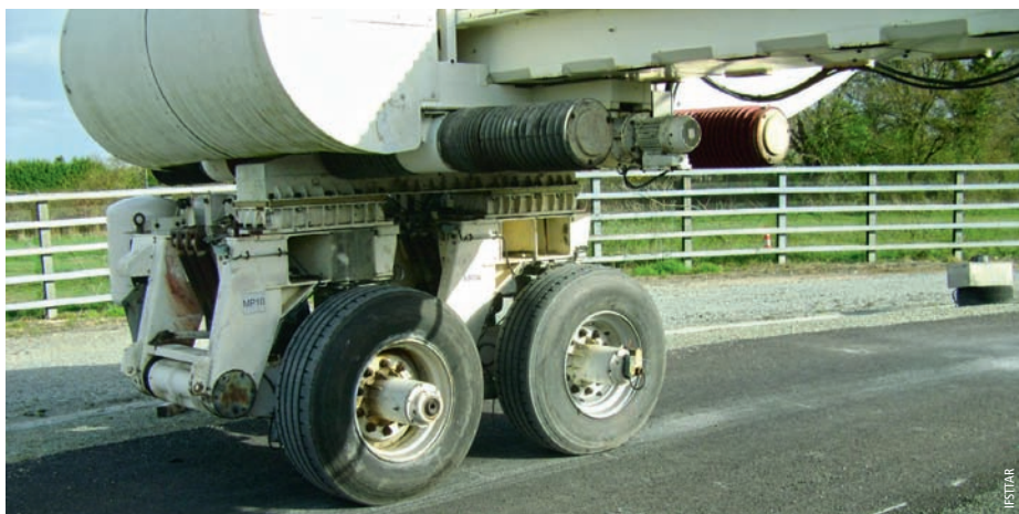
Photo 5 Configuration d'essieux tandem à roues simples Tandem axle configuration with single wheels
