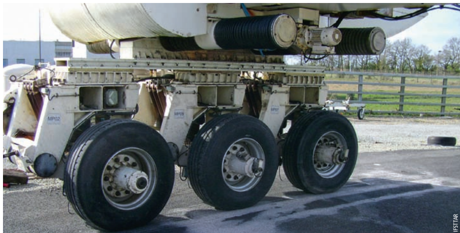
Photo 4 Configuration d'essieux tridem à roues simples Tridem axle configuration with single wheels
