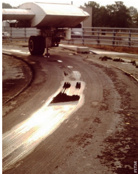
Photo 2 Profil longitudinal et orniéage sous la charge de 11,5 tonnes Longitudinal profile and rutting under 11.5-T load
