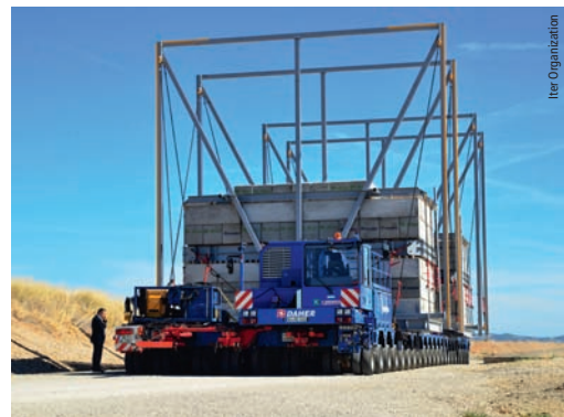
La remorque autopropulsée a cheminé pendant 4 nuits pour rallier le site Iter à Saint-Paul-lez-Durance
