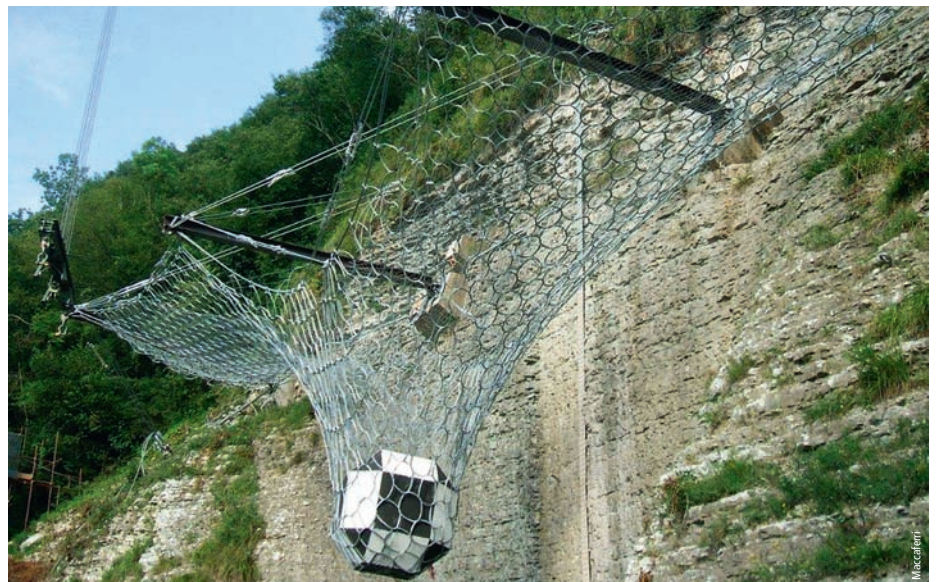
Photo 2 Test de la barrière RMC 850/A – 8 600 kJ
