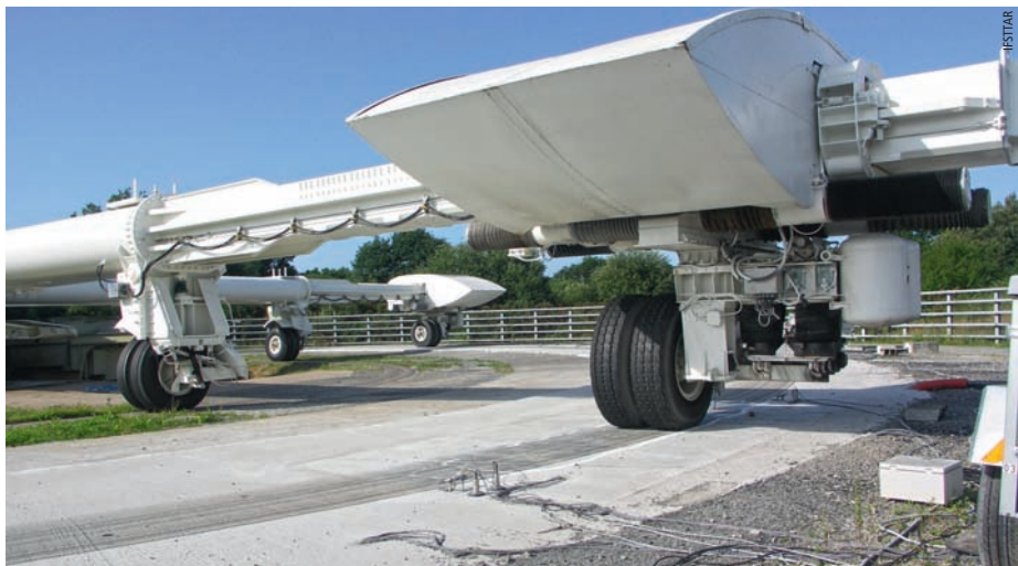
Test de la route électrique sur le manège Testing of power slab on test track
