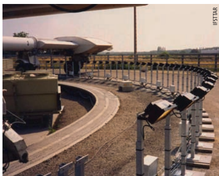
Photo 6 Système de chauffage pour l'étude de l'orniérage Heating system for rutting tests
