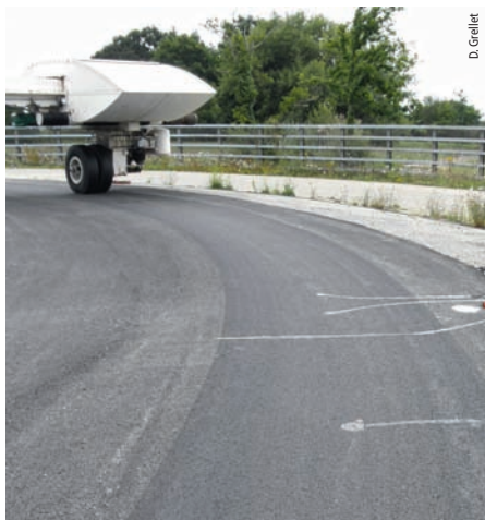
Photo 3 Passage de la roue jumelée d'un bras du manège de fatigue sur les capteurs Passage of dual wheels over sensors
