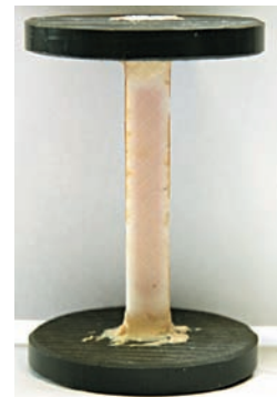
Jauge de déformation pour matériaux non liés
