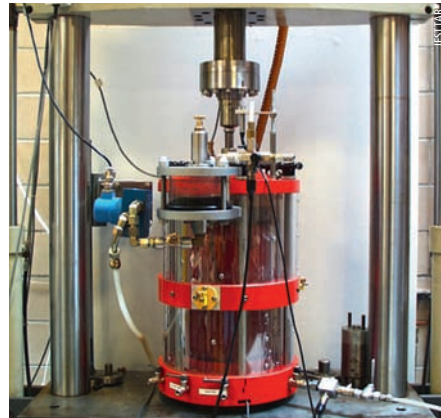
Photo 5 Cellule triaxiale pour l'étude des GNT Triaxial cell for study of untreated roadbase materials
