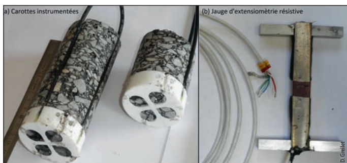
Photo 1 Instrumentation au bas de la couche de revêtement Instrumentation at bottom of wearing course
