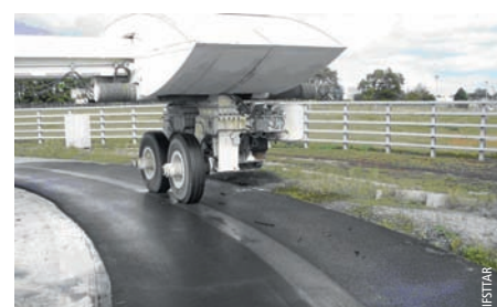
Photo 4 Départ du film de liant sur le BBTM 0/6 en fin d'essai Start of binder film on 0/6 very thin asphalt (BBTM 0/6) at end of test
