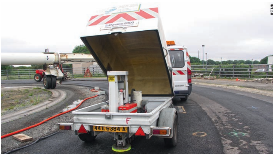
Photo 8 Essai au FWD sur les pistes du manège FWD testing on test tracks
