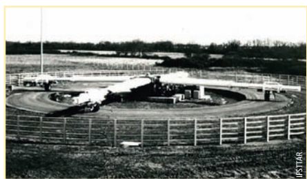
Photo 1 Première version du manège, sans les appuis intermédiaires First version of test track without intermediate supports
