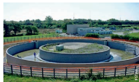
Photo 7 Vue du cuvelage de l'anneau C, permettant le contrôle du niveau de nappe dans le sol support View of ring C encasement allowing monitoring of water table in subgrade
