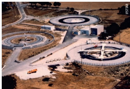
Photo 3 Vue du site du manège, après réalisation du troisième anneau View of test track site after completion of third ring
