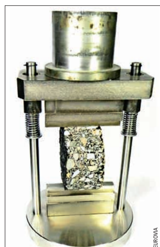
Vue du cadre d'essai et des bandes de chargement pour la réalisation de la « tenue à l'eau résiduelle » identique à celui utilisé pour la mesure de la sensibilité à l'eau des enrobés selon NF EN 12697-12 méthode A [2]
