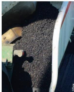
Aspect de l'enrobé Biocold avant mise en œuvre
