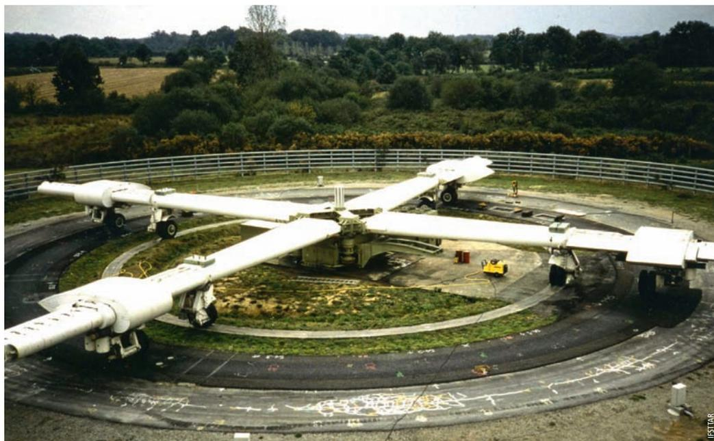
Essai de fatigue sur chaussées bitumineuses
